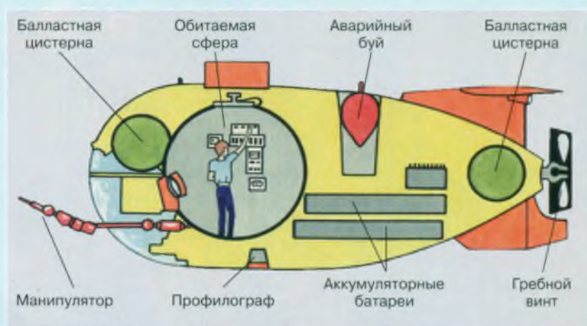
Схема внутреннего устройства подводного аппарата «Мир»
