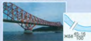
Мост (ЖБ — железобетонный, 8 — высота низа фермы над уровнем воды (на судоходных реках), 45 — длина и 16 — ширина в метрах, 100 — грузоподъёмность в тоннах)
