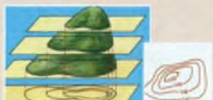
Изображение рельефа с помощью линий равной высоты — горизонтали
